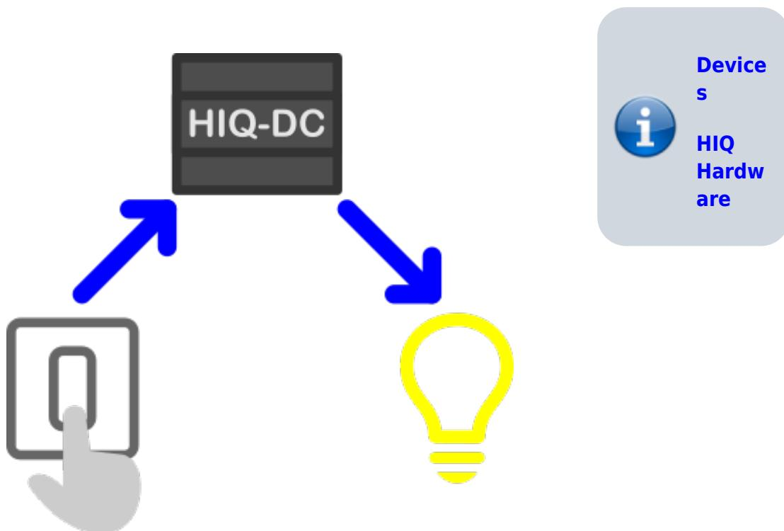
I dispositivi HiQ hardware HiQ-DC sono collegati tra loro e a HiQ-HC tramite il bus di controllo HiQ-IEX2. Le funzioni avanzate (utilità di pianificazione, scene,...) sono implementate su altri HiQ-DC o su HiQ-HC collegati. Grazie ad alta velocità e affidabile HiQ-IEX2 bus di comunicazione, queste funzioni sono veloci e affidabili.
